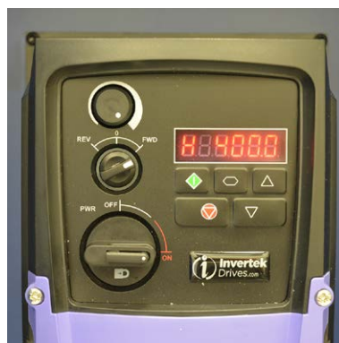
Fig. 9e Switch 3 set to the max 400 Hz
